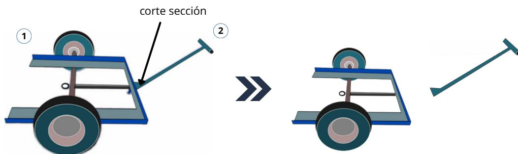
2. Apoye la plataforma en el ángulo del kit VM21 y sujetela firmemente. Marque con un rotulador la posición de los cuatro taladros y retire el kit VM21 para proceder a realizar los cuatro taladros de Ø12.
