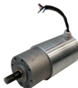
Motores T.56/4 500W 30Nm 200rpm, incluye reductor epicicloidal.
