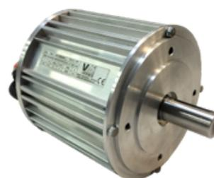
Motores brushless de alta eficiencia con imanes permanentes montado en carcasa extrusionada y fijación con brida B14
