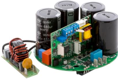
Placas para alimentación en corriente continua: Para tensiones de alimentación de 12 y 24 Vdc con amperaje máximo de motor de 17, 34 y 67 A, es decir 1600 W máx. Las velocidades estándar son de 1500 o 3000 r.p.m. aunque existe la posibilidad de programar otras velocidades.
