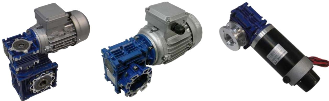
**Motor reductores de corona-infinita combinados:** Según indicaciones de nuestros clientes, en **VERNIS MOTORS** realizamos montajes especiales como motorreductores de corona-sinfín combinados que constan de dos reductores de velocidad que se acoplan para conseguir mayores reducciones de velocidad más altas. Es una solución muy sencilla y económica, pero en este tipo de montaje se debe prever un descenso del rendimiento.
